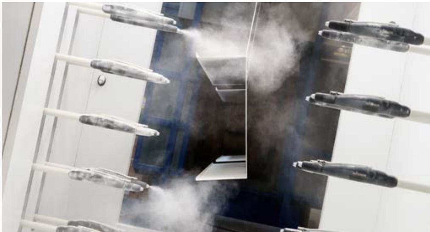
*Порошковое покрытие: после серии промывных зон обрабатываемая деталь финализируется электрическим зарядом, который в значительной степени зависит от чистоты воды. Правильное качество воды имеет важное значение для процесса предварительной обработки, независимо от того, является ли оно для гальванического покрытия, порошкового покрытия или жидкой окраски.*
